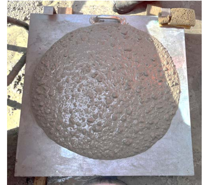
E43364R – Béton pieux PPM P4 RC-C25 C25/30 XAc 22 Cl.0,20 F5 E25 , Étalement 560-650 mm (F5-F6)
