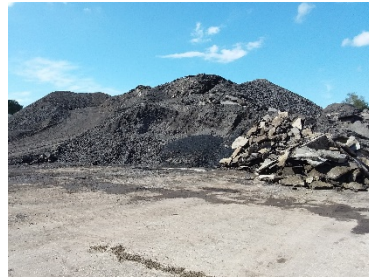
Bild 2 : Berge von Ausbauasphalt
